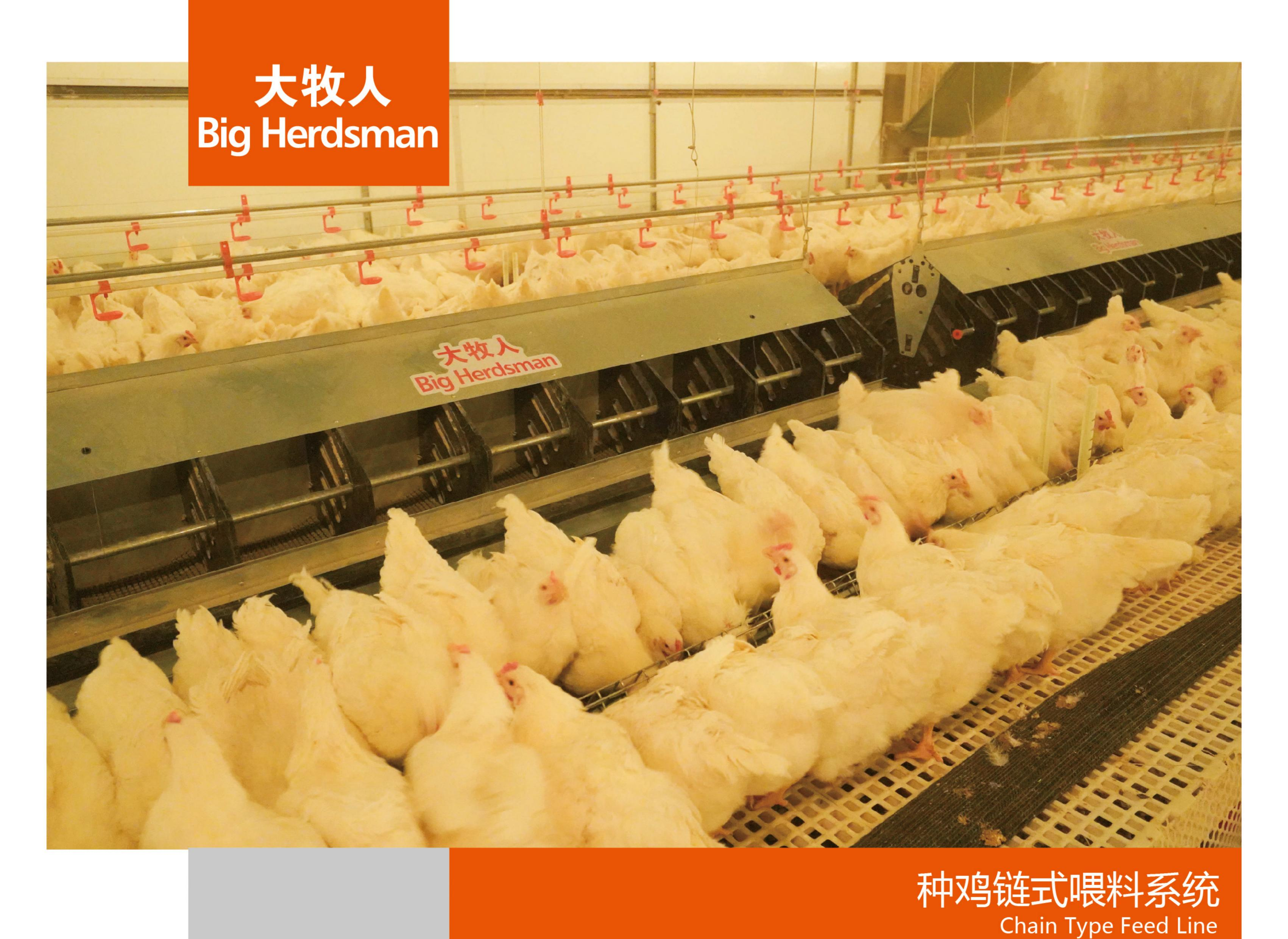
链式料线是一种可用于饲养祖代、父母代的肉种母鸡的料线。此种料线送料速度快,自动化程度高,饲料可视且易于维修。
